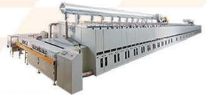
锂电、钠电正负极 材料专用辊道炉
